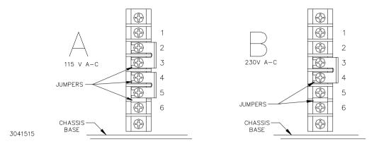
FIGURE 2-3. MAT MODULE BARRIER STRIP WITH JUMPERS FOR 115 OR 230 VA-C
